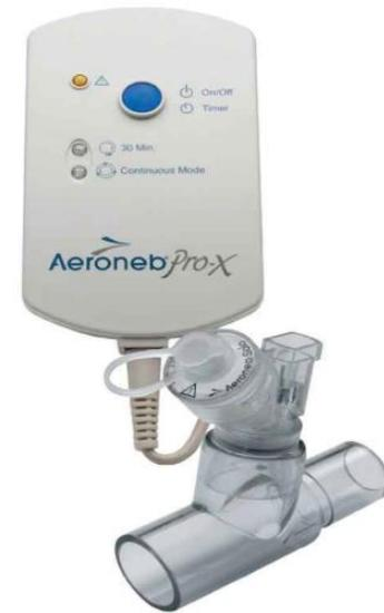
**Principe:** Un élément piézo-électrique génère une vibration à haute fréquence (1.2 et 2.4 MHz)  $\Rightarrow$  débits élevés (jusqu'à 1 ml/min)
